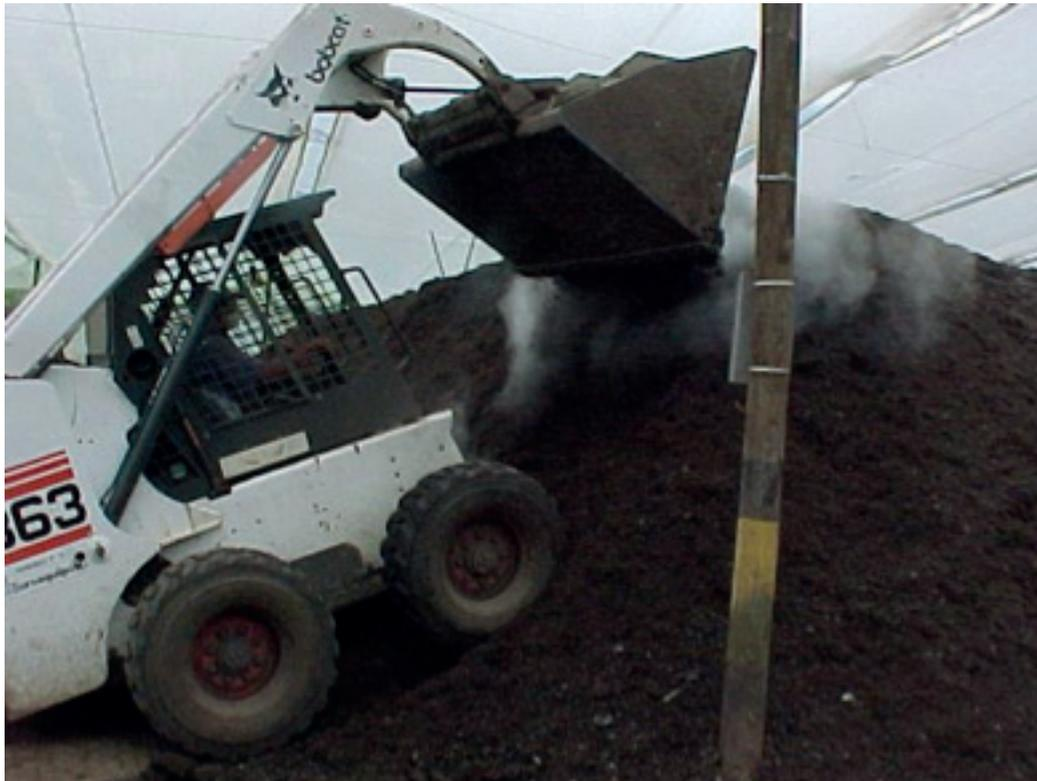
Proceso de aireación mecánica
