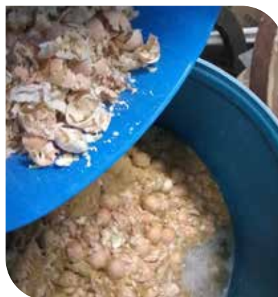
Imagen 5. Vertimiento de cáscara de huevo (lavada) sobre solución de ácido acético (reacción 1).
