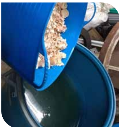
Imagen 5. Vertimiento de cáscara de huevo (lavada) sobre solución de ácido acético (reacción 1).
