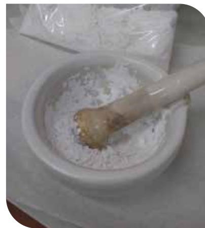
Imagen 4. Producción de hidróxido de calcio a partir del óxido de calcio de la cáscara de huevo.
