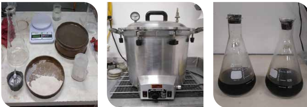
Imagen 3. Proceso de hidrólisis de la membrana para la obtención de los aminoácidos.
