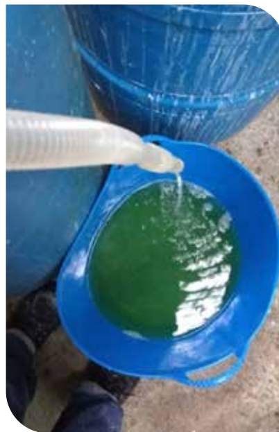
Imagen 7. Reacción del acetato de calcio con ácido cítrico, y decantación de la solución para separar el citrato de calcio precipitado y recuperar el ácido acético.
