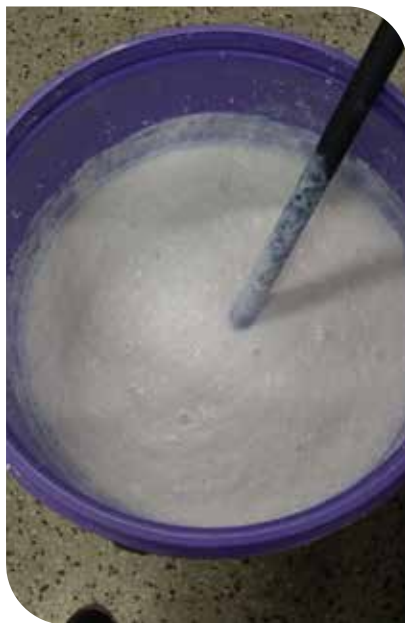
Imagen 7. Reacción del acetato de calcio con ácido cítrico, y decantación de la solución para separar el citrato de calcio precipitado y recuperar el ácido acético.
