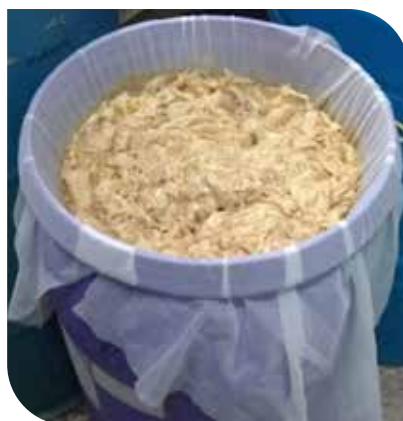
Imagen 6. Filtración del producto de la reacción 1, para separar la cáscara que no reaccionó de la solución de acetato de calcio (forma soluble de calcio).
