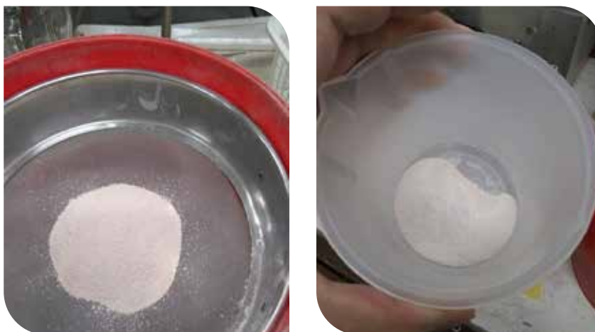
Imagen 10. Tamizado de cáscara de huevo pulverizada para obtener tamaño de partícula de 0.15 mm.
