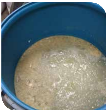
Imagen 6. Filtración del producto de la reacción 1, para separar la cáscara que no reaccionó de la solución de acetato de calcio (forma soluble de calcio).
