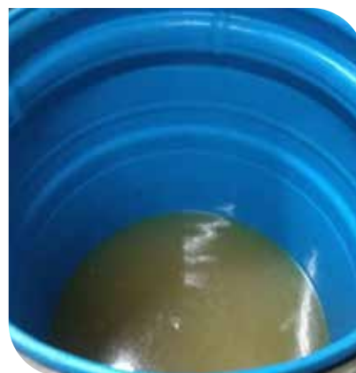
Imagen 6. Filtración del producto de la reacción 1, para separar la cáscara que no reaccionó de la solución de acetato de calcio (forma soluble de calcio).
