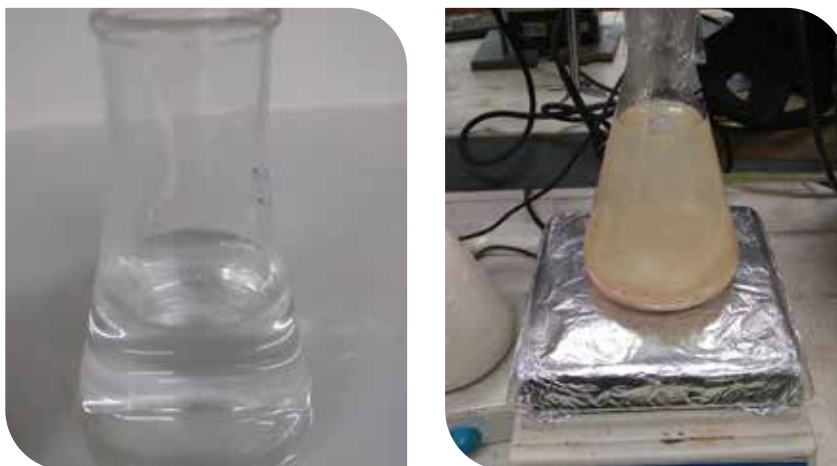
Imagen 11. Solución madre de sal de plomo y proceso de interacción con la cáscara de huevo
