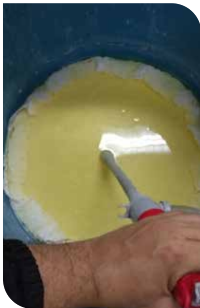
Imagen 7. Reacción del acetato de calcio con ácido cítrico, y decantación de la solución para separar el citrato de calcio precipitado y recuperar el ácido acético.
