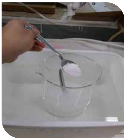
Imagen 4. Producción de hidróxido de calcio a partir del óxido de calcio de la cáscara de huevo.
