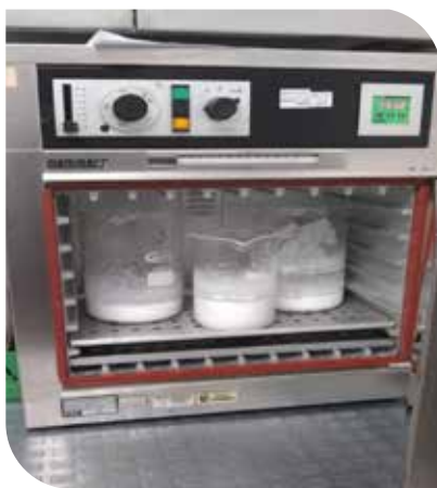
Imagen 4. Producción de hidróxido de calcio a partir del óxido de calcio de la cáscara de huevo.
