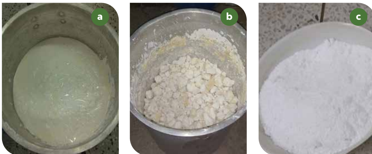
Imagen 8. Citrato de calcio (a) decantado, (b) secado y (c) molido.
